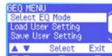
⑤ Wide / Narrowの選択を確定させると、画面表示はEQメニューに戻ります。Exitの下のファンクション・ボタンを押してEQモードの選択は完了です。
