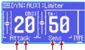
リミッターは基本的に、非常に短いアタックと比較的短いリリースの高速コンプレッサーです。Attackはリミッターが反応スピード、Sensはリミッターが作動する信号レベルです。
