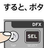
すると、ボタンを押した間隔にディレイ・タイムが設定されます。この時のディレイ・タイムは、TAPボタンを数回押した時の平均間隔に設定されます。
