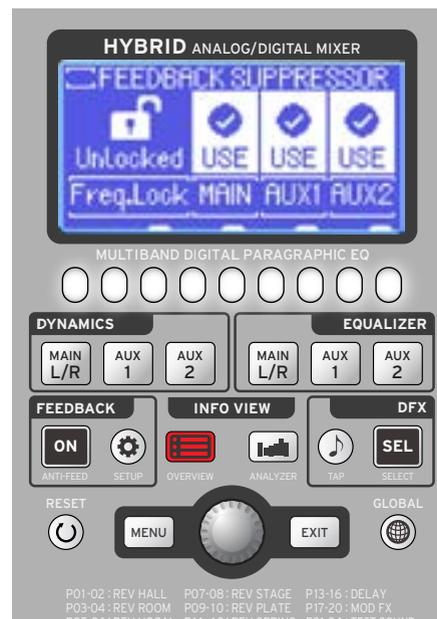
エンコーダー・ノブはクリックル・タイプで、ノブを回して設定値の変更、押してコマンドに入るなどの操作ができます。
