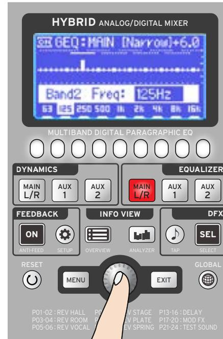
⑥ エンコーダー・ノブを回して、選択した「入口」の周波数レンジ (図の例では80Hz-200Hzのレンジ) から1/3オクターブバンドを選択します。
